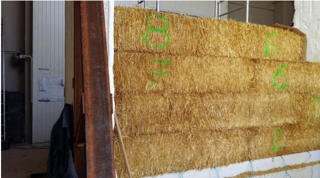
½ Mur monté dans le cadre d'essais
