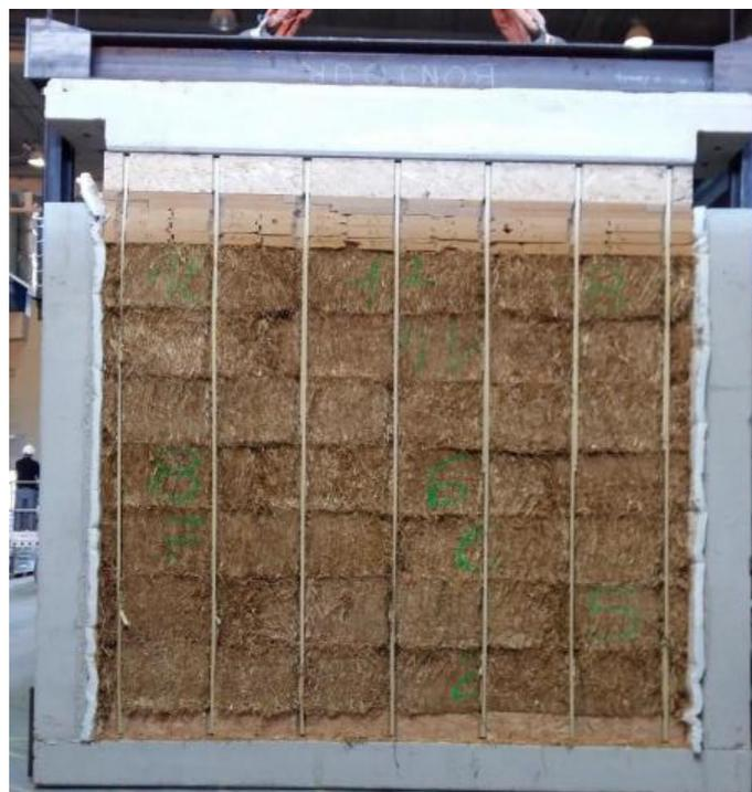
Mur monté dans le cadre d'essais
