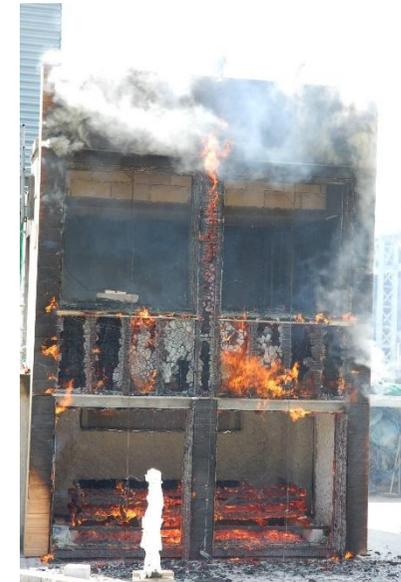
**Avis favorable** du CECMI (Comité d'Etude et de Classification des Matériaux par rapport au danger Incendie) sur les résultats de l'essai LEPIR 2 sur le type de façade testé avec un domaine d'emploi « restreint aux conditions du chantier considéré, à savoir R+2 et stabilité au feu de 30 mn (et à tous les paramètres de détail précisés dans le rapport d'essai) ».
