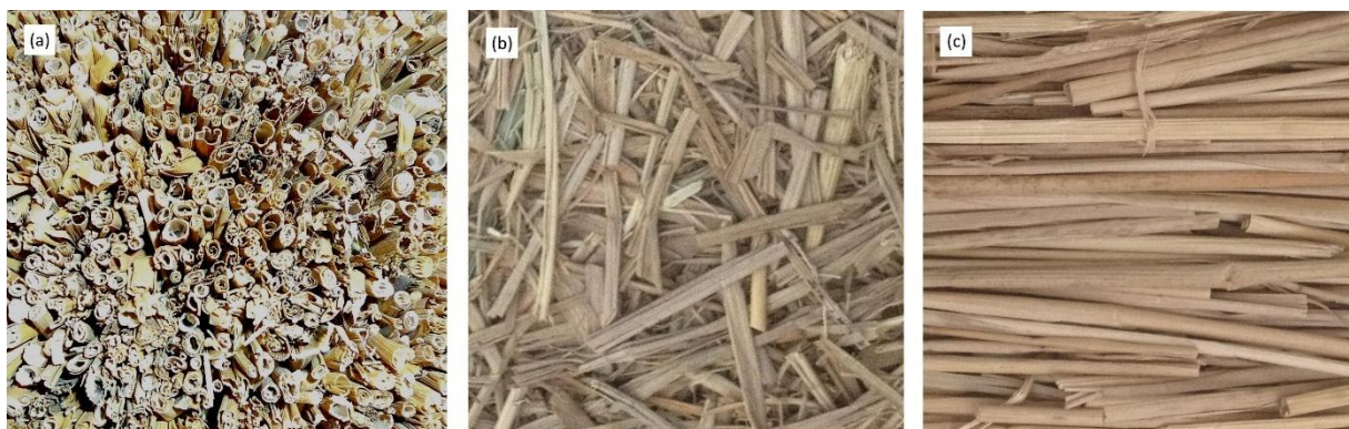
Figure 4. Photographie des différentes possibilités de l'orientation de la paille du riz par rapport au flux de chaleur : a) orientation parallèle, b) aléatoire et c) perpendiculaire [39].
