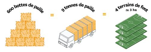
Le besoin n'est pas proportionnel à la surface de plancher. Un grand bâtiment nécessite moins de paille par m² qu'une maison individuelle. Par exemple, un lycée de 10 000 m² de plancher nécessite seulement 200 tonnes de paille.
