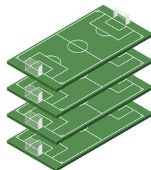
Le besoin n'est pas proportionnel à la surface de plancher. Un grand bâtiment nécessite moins de paille par m<sup>2</sup> qu'une maison individuelle. Par exemple, un lycée de **10 000 m<sup>2</sup>** de plancher nécessite seulement **200 tonnes de paille**.
