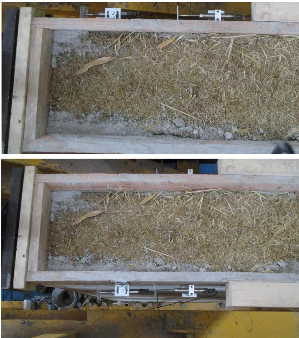
Photographie 9 : position des capteurs en partie haute du mur
