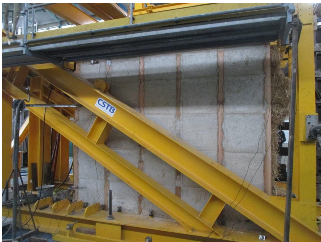
Photographie 12 : vue du mur dans le dispositif de chargement
