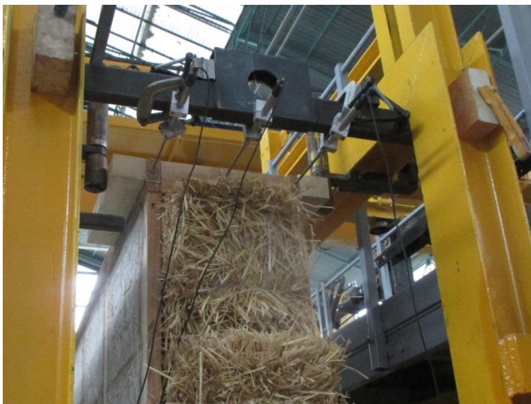
Photographie 11 : Position des capteurs de déplacement horizontal dans l'alignement du vérin, à l'opposé du vérin
