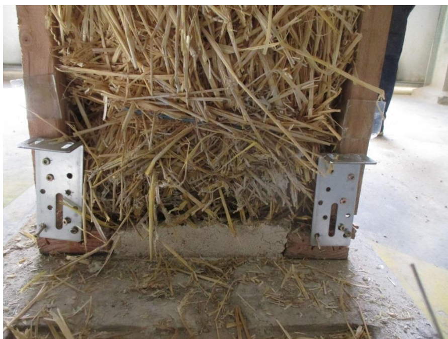
Photographie 8 : vue des équerres ajoutées en partie basse avant l'essai (photo prise après l'essai)
