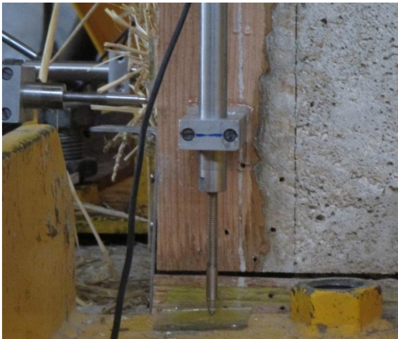
Photographie 10 : position des capteurs en partie basse du mur
