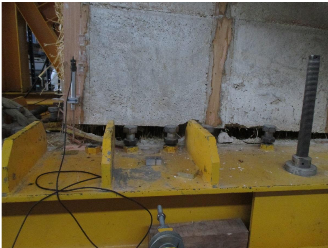
Photographie 14 : vue du grand renversement du mur (rotation du mur par rapport à la semelle)
