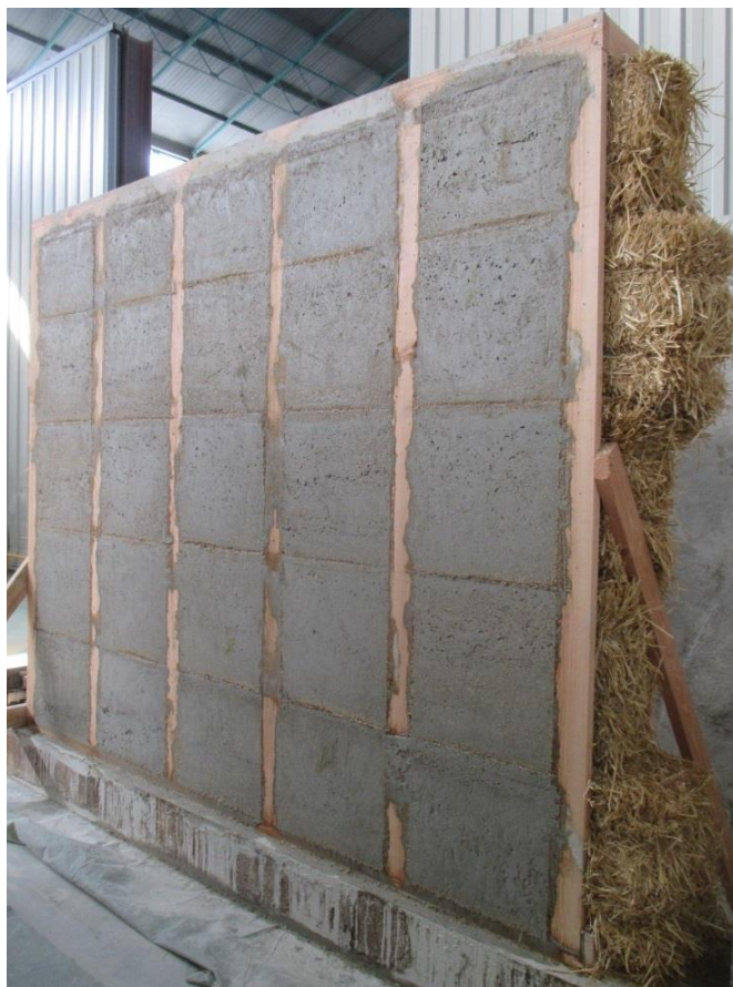
Photographie 8 : vue des équerres ajoutées en partie basse avant l'essai (photo prise après l'essai)
