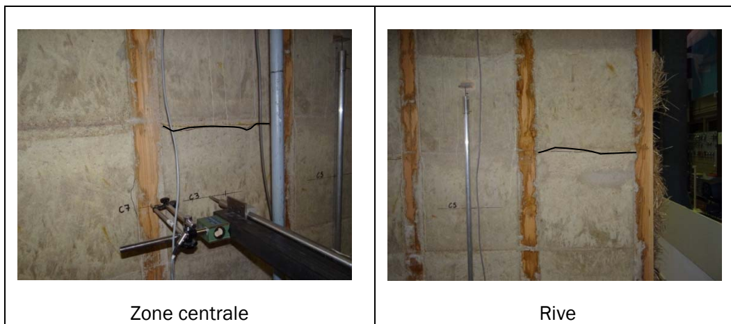
Figure 13 : Photographies des fissures face avant
