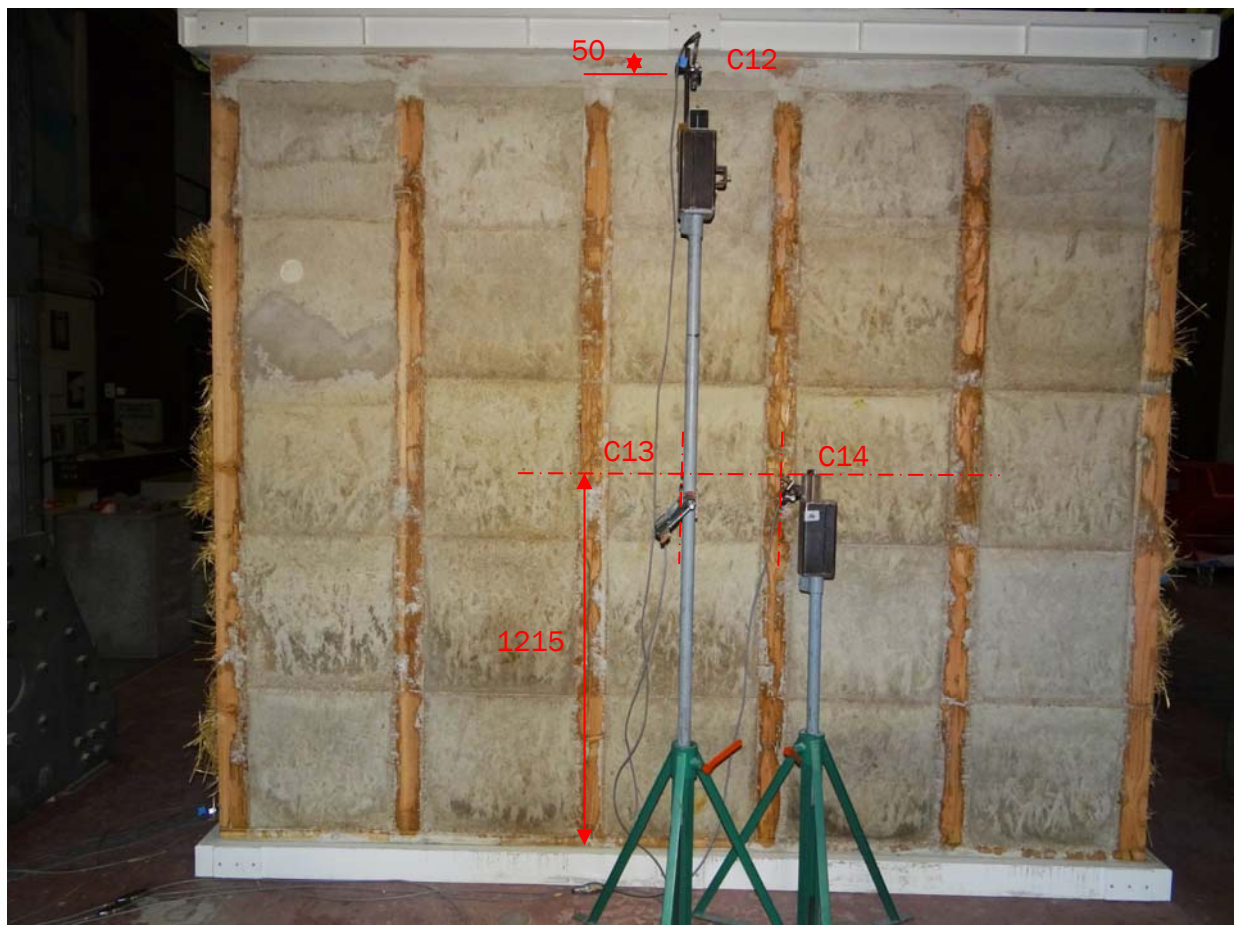
Figure 10 : Repérage et positionnement des capteurs de déplacement, face arrière
