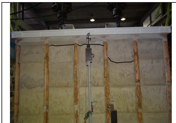
Figure 14 : Photographie des fissures face arrière
