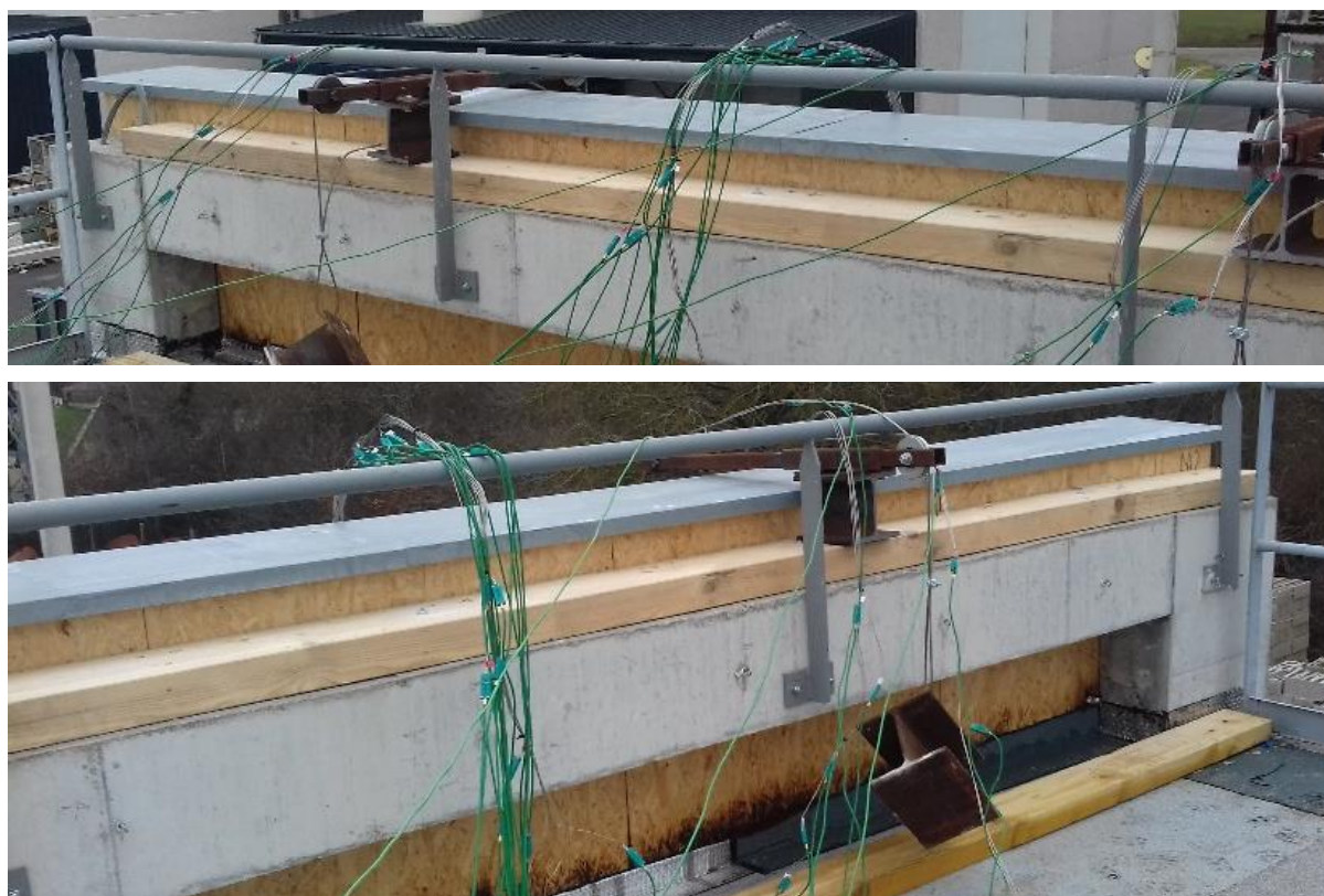
Figure 4 – Photos de la lisse en bois placée en haut du cadre d'essai pour la fixation des panneaux MOB 0-2, MOB 0-3 et MOB 0-4)
