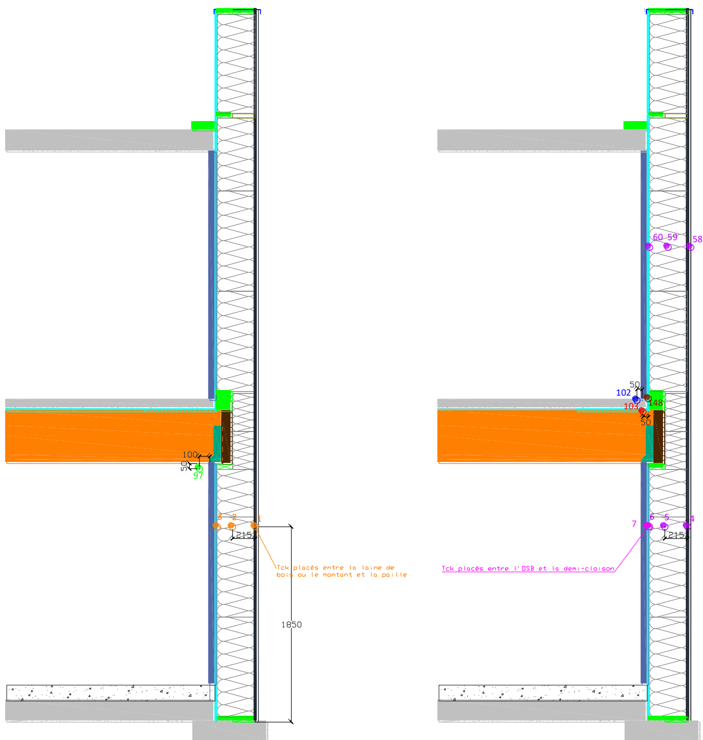
Figure 24 - Instrumentation de l'élément de façade - (A gauche) : Coupe A-A - (A droite) : Coupe B-B
