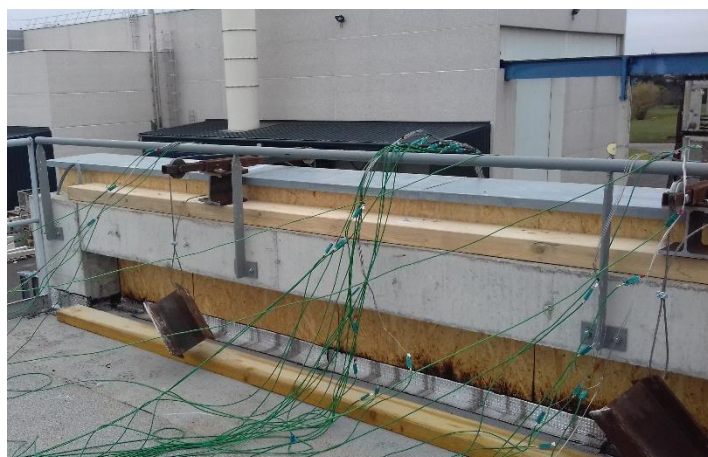
Figure 56 – Photos de la face arrière de l'acrotère avant essai
