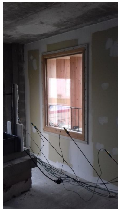
Figure 55 - Photos des fluxmètres dans le local R+1 avant essai
