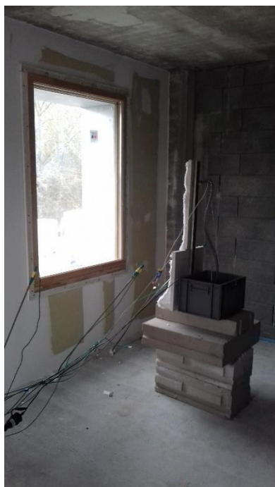
Figure 55 - Photos des fluxmètres dans le local R+1 avant essai
