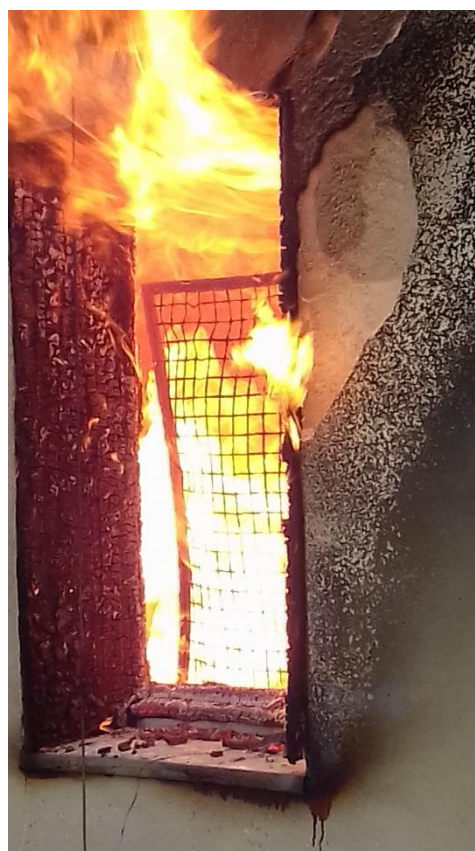
Figure 66 – Photo de la « Baie 2 » 30 minutes après la mise à feu
