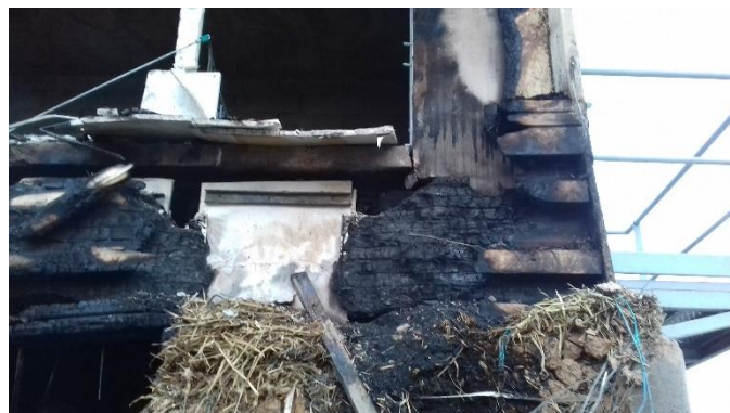
Figure 75 – Photos de la muralière après essai
