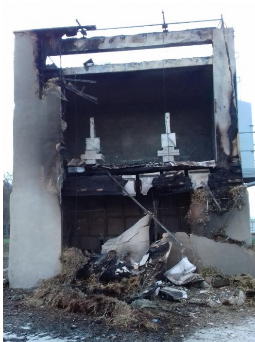
Figure 73 – Photo de la façade après essai et refroidissement
