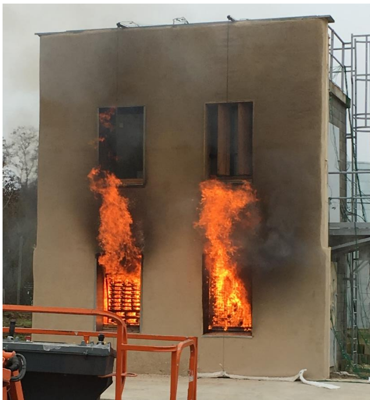
Figure 62 – Photos de la façade 10 minutes après la mise à feu
