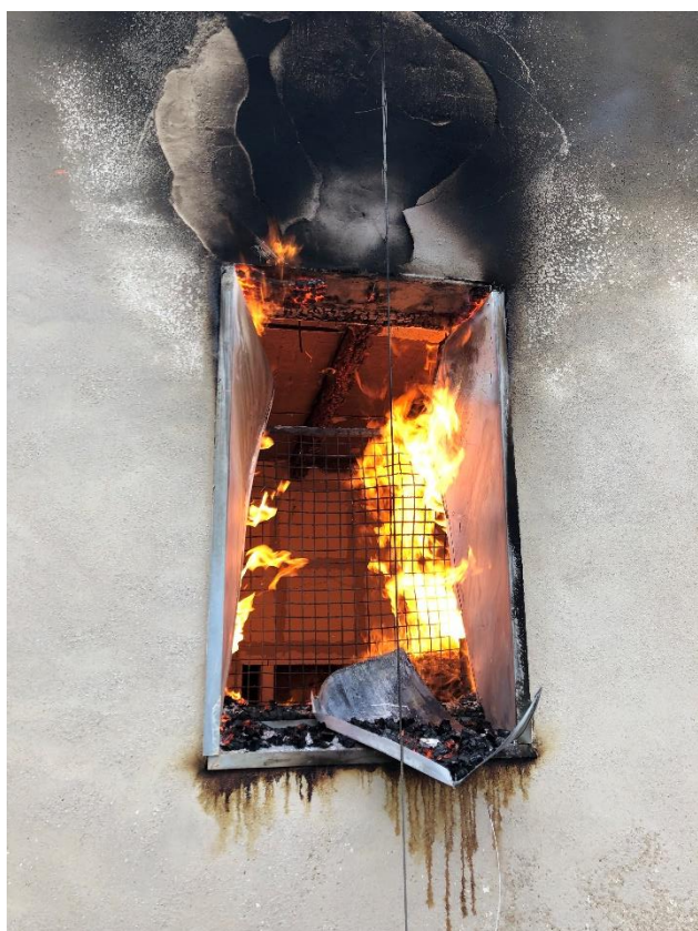
Figure 69 – Photo de la Baie 1 53 minutes après la mise à feu
