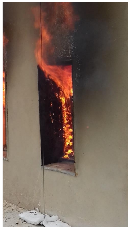
Figure 61 – Photo de la « Baie 2 » 9 minutes après la mise à feu
